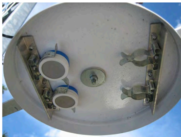
Bilden ovan. Passiva provtagare för gasformiga föroreningar som NO 2 och ozon fästs på undersidan av ett regnskydd. De exponeras vanligen under period från en vecka till en månad och analyseras sedan på laboratoriet för att fastställa den genomsnittliga halten under exponeringsperioden.
