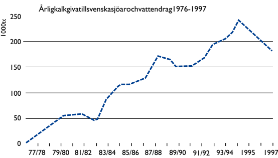
Kalkspridning i ytvatten sedan mitten av 1970-talet. Som mest spreds ca 250 000 ton kalkstenspulver per år i svenska sjöar och vattendrag. Kalkningen måste fortsätta ända tills utsläppen nått under kritiska gränser och markens svavelförråd tömts.
